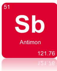
Der Rohstoff Antimon wird für **Bleilegierungen** bspw. in Blei-Säure-Batterien, als **Flammschutzadditiv** für Kunststoffe und Textilien oder als **Katalysator in der chemischen Industrie** verwendet. Die Zukunftsperspektiven des Einsatzes von Antimon sind besonders brisant, weil die globalen Vorkommen schätzungsweise nur noch **18 Jahre ausreichen**.
